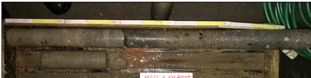
Obr. č. 1 - diagnostický vrt V2 - do opěry Č. Třebová
