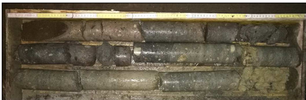
Obr. č. 2 - diagnostický vrt Š2 - do opěry Č. Třebová
